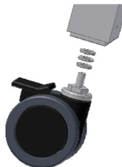
6.2.1 Presione la palanca del freno y enrosque cada una de las ruedas en cada pata. No olvidar de colocar tres arandelas en cada rueda.
