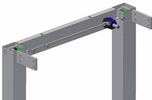
6.1.1 Compruebe que la altura (L) de las 4 patas es idéntica. Pueden ser ajustadas en el eje hexagonal mediante la llave suministrada. Coloque los laterales en una superficie plana y monte las patas. Vea las etiquetas.
